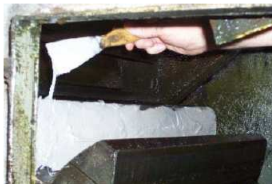
Sporządzenie silikonowego odcisku powierzchni nośnej zęba zębniaka obracającego się do zewnątrz, przy zatrzymanym napędzie
