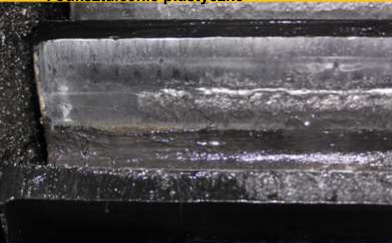
zużycie ścierno-adhezyjne, zatarcia i odkształcenie plastyczne
