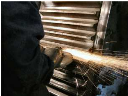
Przeszlifowanie powierzchni nośnej zęba szlifem krzyżowym ściernicą wachlarzową; jakość powierzchni uregulowana po obróbce wykańczającej
