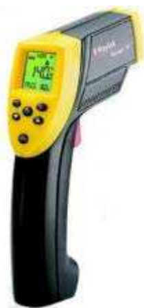
Termometr na podczerwień do bezstykowego pomiaru temperatury powierzchni nośnych zębów w czasie pracy
