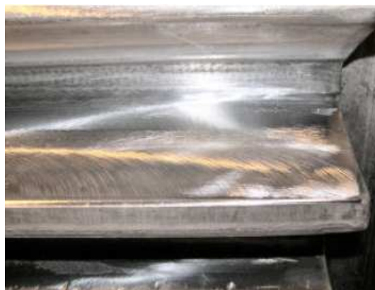
Taka sama powierzchnia nośna zęba bez jakiegokolwiek stopnia zużycia po obróbce mechanicznej i szlifowaniu krzyżowym; jakość powierzchni: po obróbce wykańczającej
