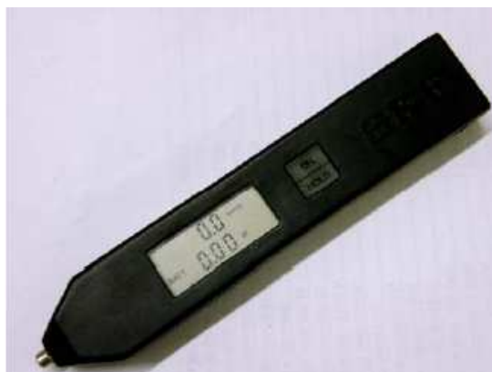
Przyrząd do pomiaru prędkości drgań i ich przyspieszenia w trakcie ruchu
