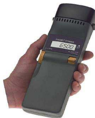
Stroboskop czyni widocznymi powierzchnie nośne zębów w trakcie ruchu
