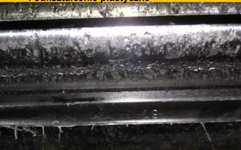
zużycie ścierno-adhezyjne, zatarcia i odkształcenie plastyczne
