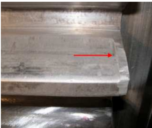
Powierzchnia nośna zęba o wyraźnie widocznym uskoku w wyniku zużycia, przed obróbką mechaniczną
