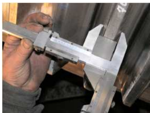
Pomiar powierzchni nośnych i sporządzenie profilu
