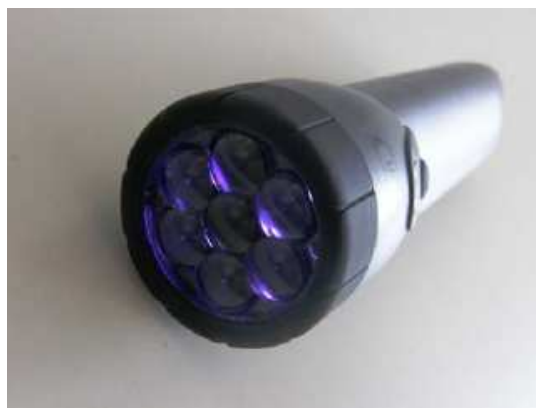
Lampa UV do uwidocznienia ilości transparentnych środków smarowych Klüber na powierzchniach nośnych zębów dużego napędu
