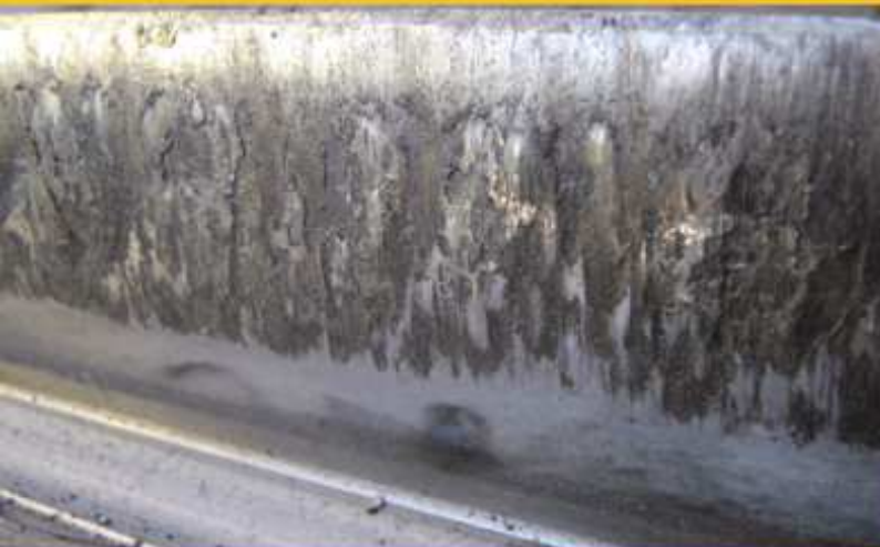
zużycie ścierno-adhezyjne i odkształcenie plastyczne
